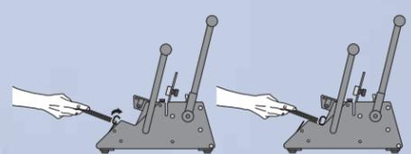
Das Papier kann nach dem Stanzen sofort in das Drahtkamm-Bindeelement eingehängt werden. Die fertige Broschüre danach direkt in die davor liegende Schließeinheit schieben und schließen. (am Beispiel RW 360, SRW 360, SRW 360 comfort)
