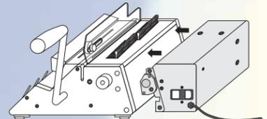
Ein absolutes Novum in dieser Maschinengeneration ist der modulare Antrieb. Durch ein neuartiges Stecksystem kann der Kunde jetzt mit wenigen Handgriffen sein bereits vorhandenes Handstanzgerät zu einem Gerät mit elektrischer Stanze ausbauen.
