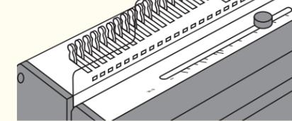
Die genaue Einstellung auf die verschiedenen Drahtdurchmesser lässt sich durch einen Schieber an der Oberseite des Geräts mittels einer Skala sehr einfach durchführen. Schnelle Formatumstellung durch ausschaltbare Stanzstempel.
