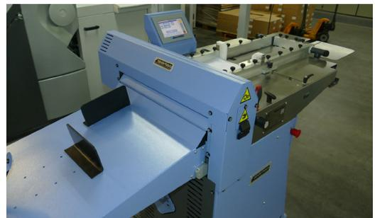
Die Balkenrillmaschine R50/10 von binderhaus beherrscht Nuten, Rillen, Perforation und Mikroperforation mit bis zu 10.500 Takten pro Stunde. Maximal 50 cm breite Bogen (bis zu 600 g/m<sup>2</sup>) rillt sie so vor, dass beim Falzen nichts aufplatzt.
