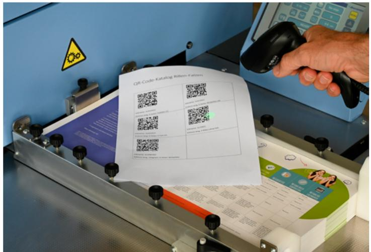
Sämtliche Baureihen der blauen Nut- und Rill-Falzmaschinen aus dem Hause binderhaus lassen sich ab sofort per QR-Code einrichten.
