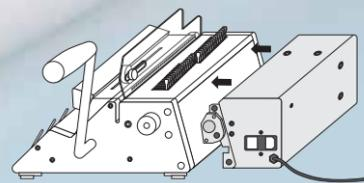
Ein absolutes Novum in dieser Maschinengeneration ist der modulare Antrieb. Durch ein neuartiges Stecksystem kann der Kunde jetzt mit wenigen Handgriffen sein bereits vorhandenes Handstanzgerät zu einem Gerät mit elektrischer Stanze ausbauen.
