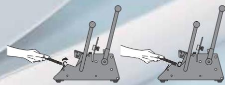
Das Papier kann nach dem Stanzen sofort in das Drahtkamm-Bindeelement eingehängt werden. Die fertige Broschüre danach direkt in die davor liegende Schließeinheit schieben und schließen. (am Beispiel eco C 360, eco S 360, eco 360 comfort)
