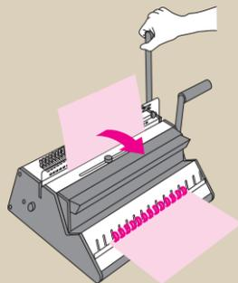
**Schritt 2** Bindegut fällt bündig in den senkrechten Stanzschacht. Mit geringem Kraftaufwand stanzen spezialgehärtete Stanzmesser die Papierlagen. Gestanztes Papier in das Bindeelement einhängen.
