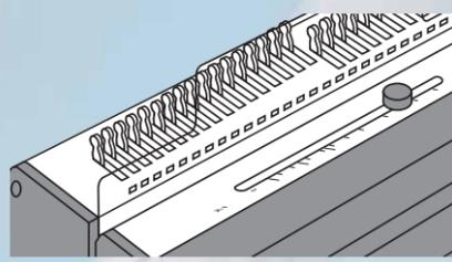
Die genaue Einstellung auf die verschiedenen Drahtdurchmesser lässt sich durch einen Schieber an der Oberseite des Geräts mittels einer Skala sehr einfach durchführen. Schnelle Formatumstellung durch ausschaltbare Stanzstempel.
