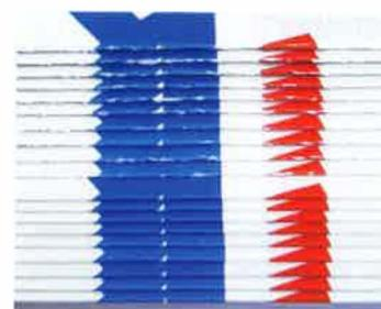
Rillen auf der R50/FSA: oben ungerillte Bogen, unten gerillte Bogen ohne Aufplatzen im Falzbruch.
