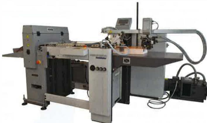
Nutmaschine R50/FSA bis 14.000 Takte/ Stunde mit dem weltweit bewährten Heidelberg-Stahlfolder Anleger.
