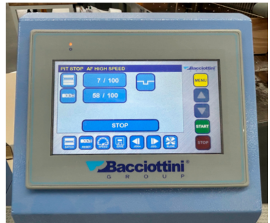
Der Bediener steuert die Balkenrillmaschine der Bacciotini Group intuitiv über ein farbiges 7-Zoll-Touchscreen-Panel.
